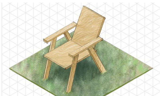
Desenho do professor Marcelo, demonstrando o uso de grid axonométrico como apoio à perspectiva.
